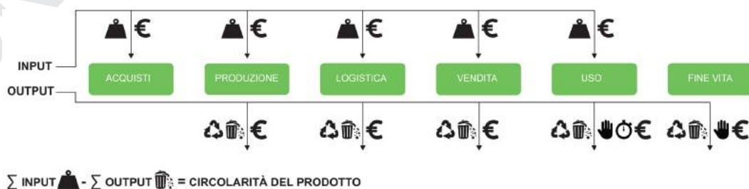
Grafico 15 – Schema dei flussi per la misurazione della circolarità di un prodotto e/o servizio
